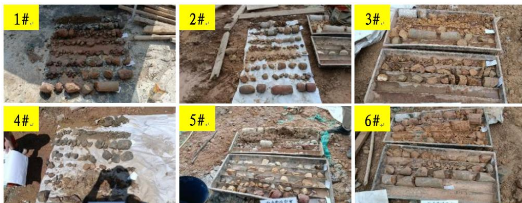
图 19 事发水泥罐各支柱下方岩芯照片图
