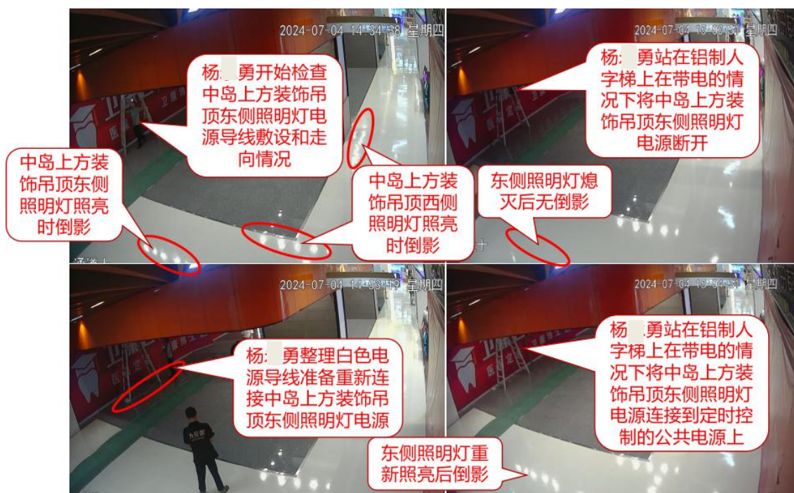
图 4 杨某勇站将中岛上方装饰吊顶东侧照明灯电源线连接到公共电源上情况视频截图
