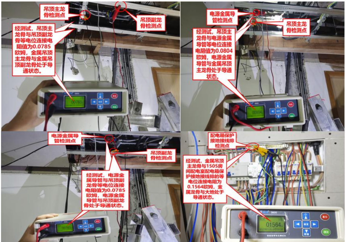
图 20 田某洪作业位置周围导体等电位测试勘查图
