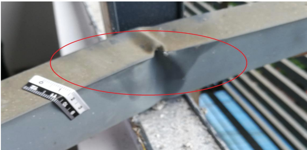
图4-8、水贝茂名大厦409室断开的铝条变形处有疑似手指印痕
