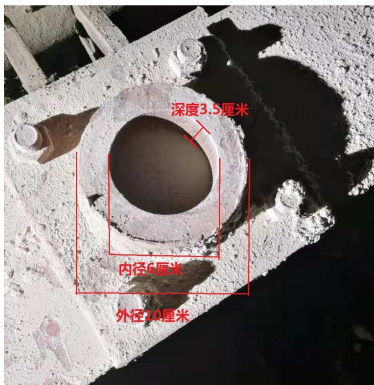
图 10 事发时砸到张峰华头部的 3 号纵梁上的方形钢板
