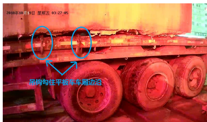
图4 吊钩勾住平板车车厢的位置(来自监控视频截图)
