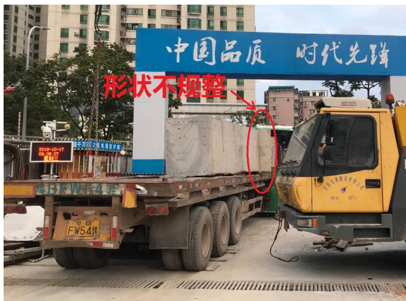
图 18 混凝土块形状不规整
