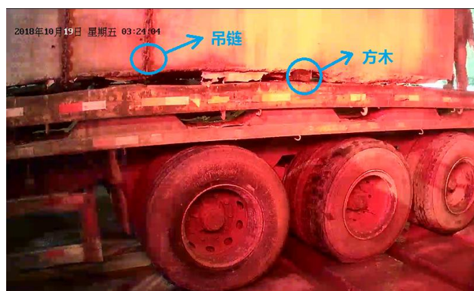
图2 第五块混凝土块吊放位置（来自监控视频截图）
