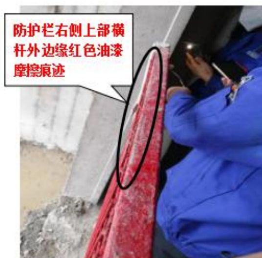
图 7 事发处防护栏右侧上横杆摩擦痕迹勘查图 拍摄人：谢君 拍摄时间：2020 年 4 月 2 日 16 时 05 分
