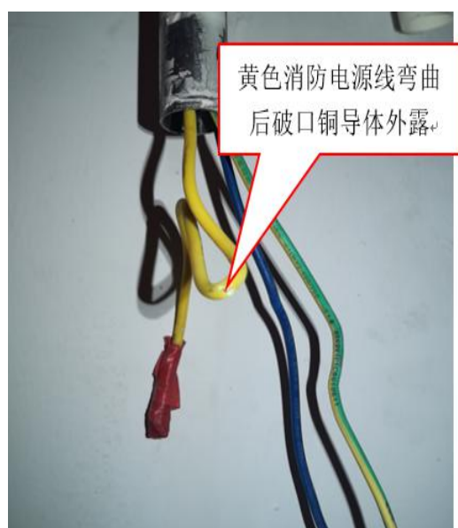
图 10 事发黄色消防电源线破口勘查图
