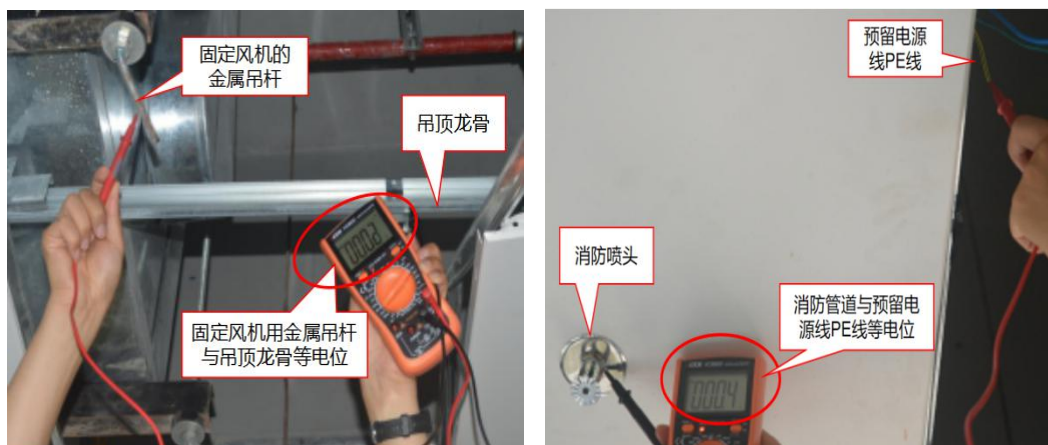
图 10 事发洗碗间主间 3#方片灯安装预留口周围金属部位带电情况勘查图
