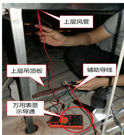
图 26 通风管道与电源线 PE 保护接地线 为等电位检测图
