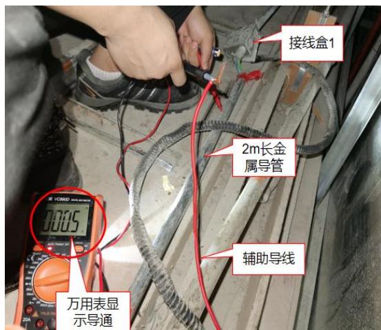
图 27 接线盒 1 西侧 2m 长金属导管与 电源线 PE 保护接地线为等电位检测图
