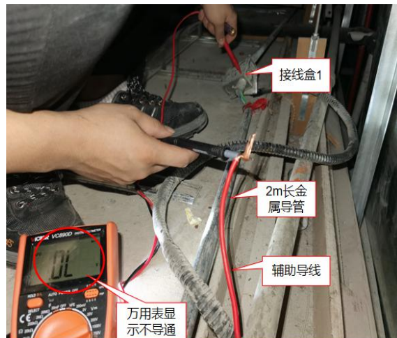
图 28 事发段金属导管与电源线 PE 保护 接地线不是等电位检测图
