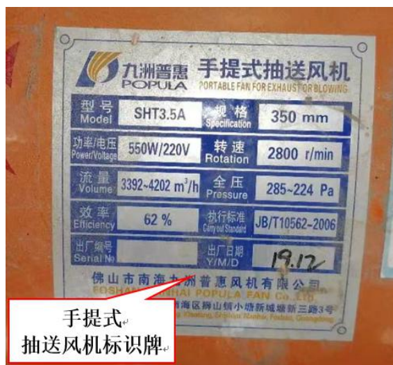
图 15 手提式抽送风机参数勘查图
