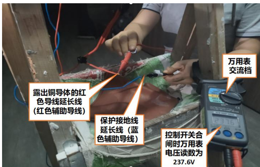
图 12 事发吊顶内各类金属导体及 A 金属导管内导线带电可能性测试图
